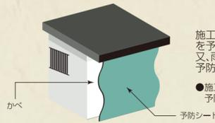
施工中から強い陽射しを避け、急激乾燥を予防します。又、雨に濡れるのも強度が低下しますので予防します。
